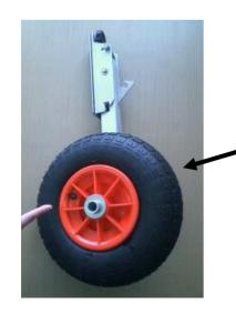
※空気注入口が外側になるよう取り付けて下さい。
