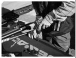
ドリル(刃6.1ミリ)で穴を明け、回りのバリを取り除き連結ボウルベースを上から皿ビス、下からM6ワッシャー、M6ナイロンナットで締めます。
