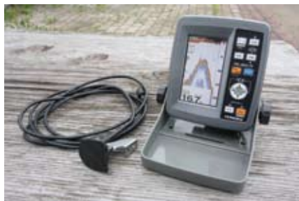
標準ではちょいナビ本体と振動子（センサー）、トランザム金具の3点セット。釣りに使うなら、オプションの水溫センサーは必須ですよ！
